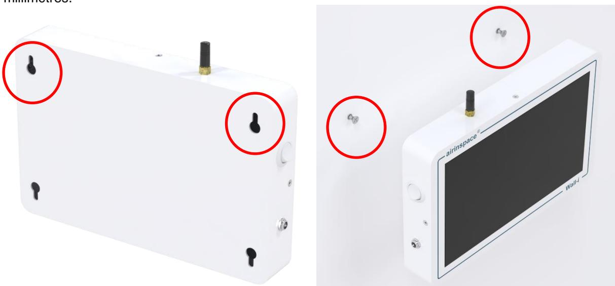
Placer le **Wall-i ISO** sur les deux vis précédemment fixées au mur. Utiliser les deux découpes en forme de tête de serrure (voir ci-dessus) pour faire passer la tête de vis puis laisser reposer l'appareil. Serrer ou desserrer les vis pour améliorer l'accroche.
