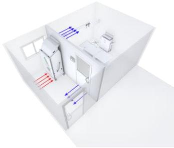
C. Ségrégation de la zone opératoire pressurisée et création d'un espace « sas » par une cloison modulaire salle propre
