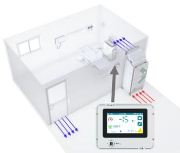
B. Purificateur d’air utilisé pour mettre en pression le local accueillant la zone opératoire et asservi à un boîtier de contrôle de pression
