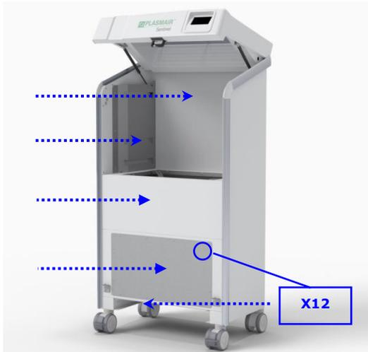
Limpie la superficie interna de la puerta frontal, la cámara del módulo y las superficies de la carcasa ahora accesibles; a continuación, retire el panel de acceso de la cámara de succión con una llave Allen de 2,5 mm (12 tornillos).
