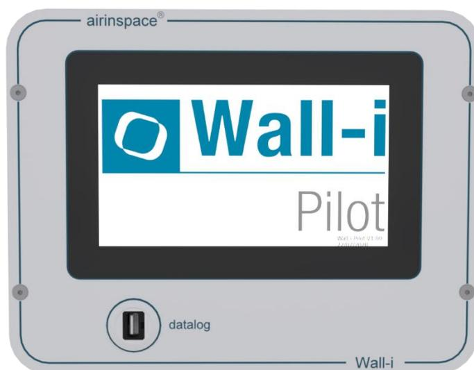
Lorsque l'unité de traitement d'air **airinspace®** est mise en marche, le **Wall-i Pilot** entre en phase d'initialisation. Cette étape peut durer de 20 à 30 secondes. Elle correspond au contrôle et pilotage du ventilateur de l'unité de traitement d'air, afin d'atteindre la consigne de pression souhaitée. Par défaut la consigne est de +15Pa en version positive et -15Pa en version négative.
