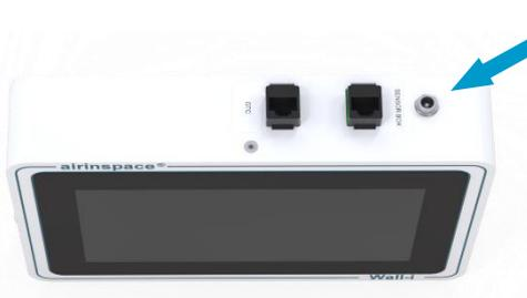
Vérifier l'alimentation électrique du **Wall-i Watch** à la prise jack (24Vcc).
