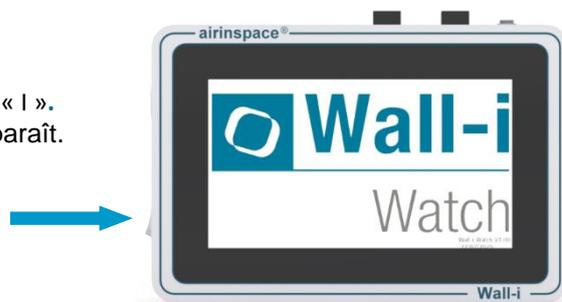
Le **Wall-i Watch** entre en phase d'initialisation. Cette étape dure 20 à 30 secondes. Elle correspond aux contrôles de la pression, la température et l'hygrométrie dans le **boîtier sonde** par le **Wall-i Watch**. Par défaut la consigne est de +15Pa en version positive et -15Pa en version négative.
