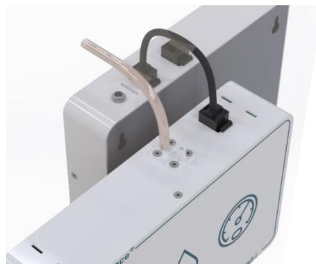
Raccorder électriquement le **Wall-i Watch** au **boîtier sonde** à l'aide d'un câble RJ45 droit. Positionner le câble RJ45 droit sur le connecteur RJ45<sub>1</sub>, identifié **Sensor box**.
